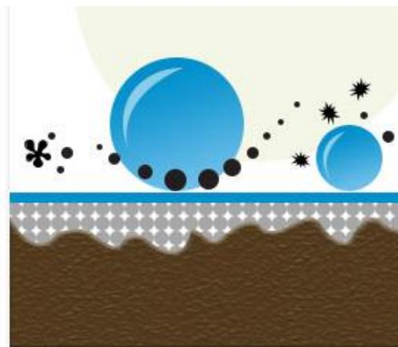
Нано-частицы создают защитный барьер, отторгающий воду и грязь, защищающий от ультрафиолета, химический и механических воздействий.
